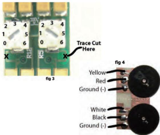
図 3 はゲイン調整用のトリムポットの拡大写真です。左側のポットはそのチャンネルが使用されていないためゲインが 0 にセットされています。右側のポットは 2 に設定されています。ピックアップの感度によりゲインは調整する必要がありますが、初めは 2 から試してみてください。
