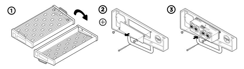
4X MOD Pro V2をテンプルボードのモジュラーエンドパネルにマウントすることで、ボード側面から1/4インチの 入出力をルーティングできるようになります。
